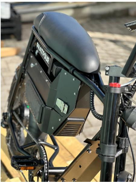
In collaborazione con l'olandese Phatfour, H2Planet realizza la H-Bike 3, la nuova bicicletta elettrica a pedalata assistita il cui sistema di ricarica è gestito dal nostro sistema di stoccaggio a idrogeno brevettato.
