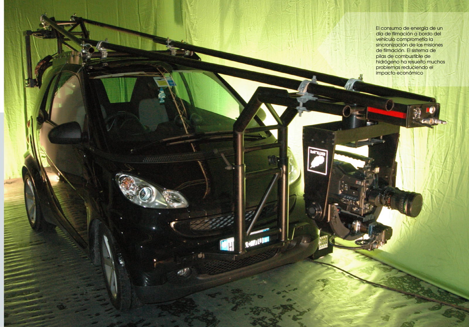
El brazo mecánico robótico del vehículo permite la máxima flexibilidad en la filmación de películas en movimiento
