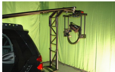
El brazo mecánico robótico del vehículo permite la máxima flexibilidad en la filmación de películas en movimiento
