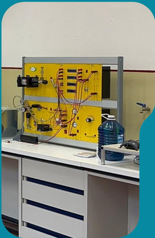
**Il pannello didattico di ultima generazione per lo studio e il test della tecnologia fuel-cell PEM a idrogeno fino a 100W con carico variabile incluso e idruro metallico MyH<sub>2</sub> 300 da 300 litri incluso per 3 ore di autonomia.**
