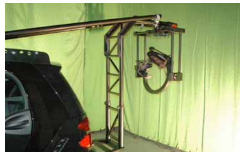
Il braccio meccanico robotizzato a bordo veicolo consente la massima flessibilità nelle riprese cinematografiche in movimento
